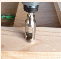
①埋木錐を材にしっかりと押し付けてから回転させる。
